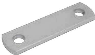
CHAPA JUMELO MOLA DT ENTRE CENTRO 85MM FURO 12,7MM 48304.331
