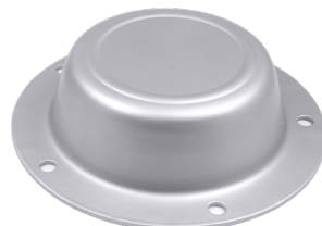
TAMPA 5 FUROS 10,5X106MM Ø 205 ALTURA 54MM GUERRA 13.560.620
