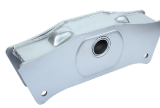
BALANÇA CARRETA REFORÇADA PINO 50,85MM MOLA 90MM FACCHINI 2012
