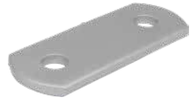
CHAPA JUMELO MOLA DT ENTRE CENTRO 100MM FURO 12,5MM MB 912
